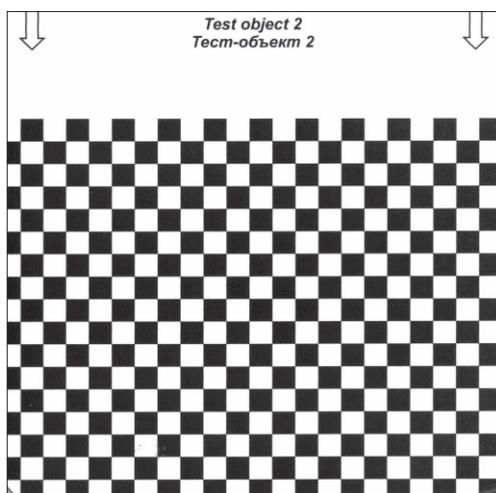
Сканер выполнит считывание мишени 2, после чего на сканере слева загорится зеленый светодиод, символизирующий об успешном окончании калибровки.
