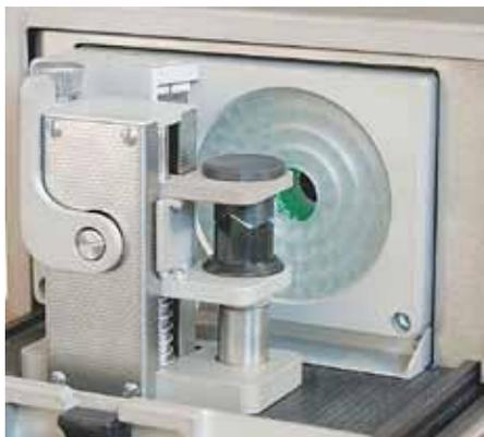
3. Установить на шпиндель сканера узел фиксации и совмещения оси гильзы с осью объектива сканера и закрепить его винтом.
