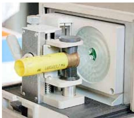
6. Зафиксировать гильзу в узле фиксации.
