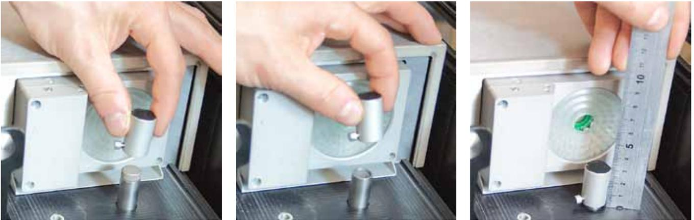
Для сканирования нижней части образца следует приподнять оправку на шпинделе и закрепить фиксирующим устройством:
