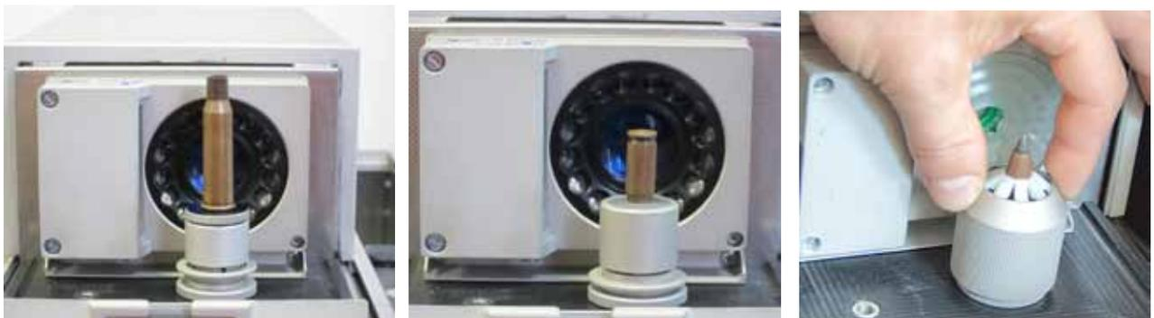
Если гильза изготовлена с применением магнитных материалов, то используется **магнитная оправка**.
