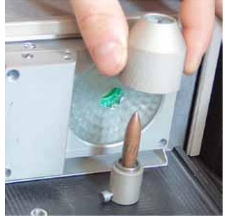
2. Для центровки пуль (гильз) диаметром 9-22 мм применяются следующие приспособления:
